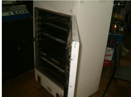
Resim 2.22: Sıcak hava üfleme aparatı ve kurutma fırını
