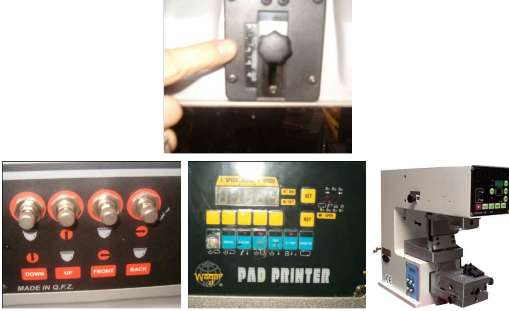
Resim 2.18: Farklı tampon baskı makinesi kontrol panelleri
