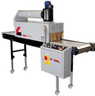
Resim 2.22: Sıcak hava üfleme aparatı ve kurutma fırını
