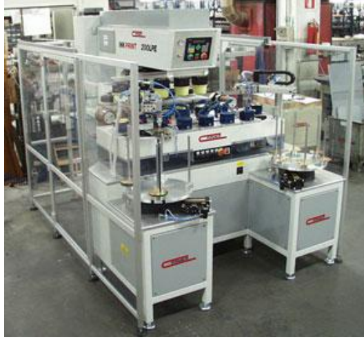
Resim 2.21: Otomatik baskı materyali besleme aparatlı tampon baskı makineleri
