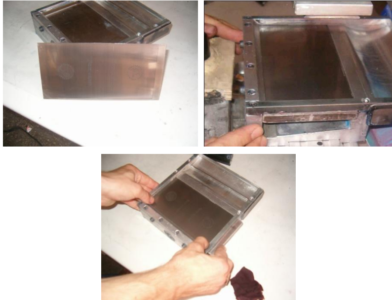
Resim 2.15: Kalıp takma bölümü
