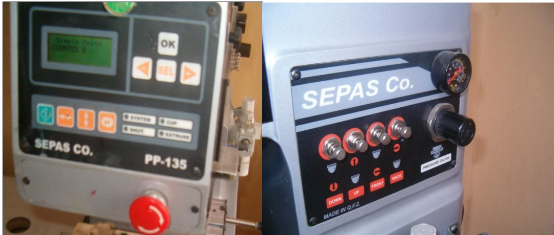
Resim 2.4: Tek kafalı tampon baskı makinesi kontrol panelleri
