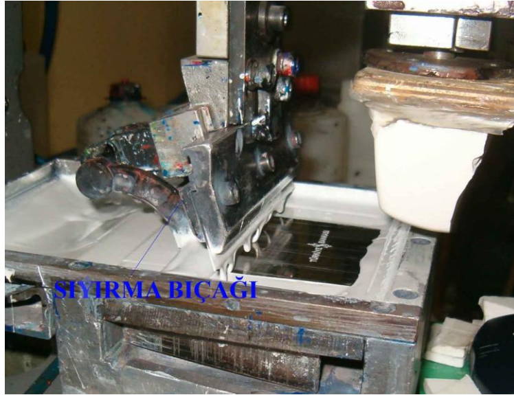
Resim 1.9: Mürekkep sıyırıcı bıçak
